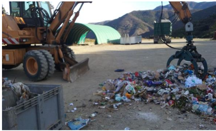
Figure 8. Brassage et prélèvement de l'échantillon secondaire de 125 kg.
