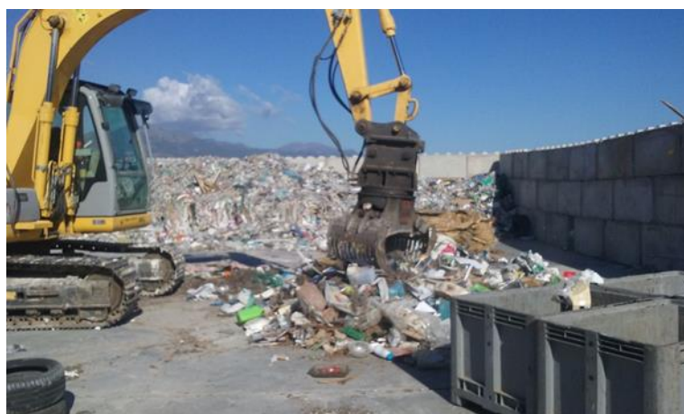
Figure 15. Homogénéisation et échantillonnage de la fraction < 400 mm
