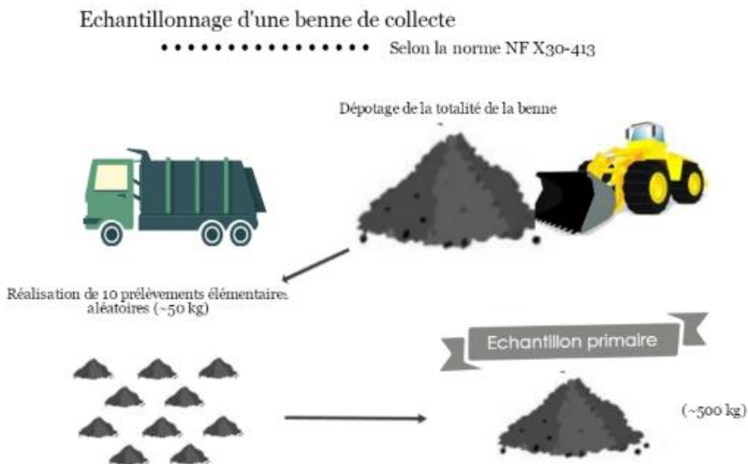
Figure 4. Schéma global de constitution des échantillons d'OMR.
