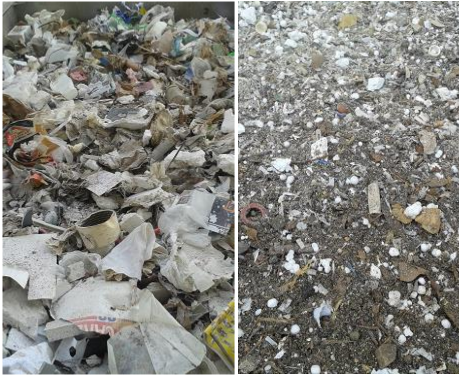
Figure 16. Éléments moyens (fraction 100-400 mm) et éléments fins (fraction < 100 mm) d'une benne de TV.
